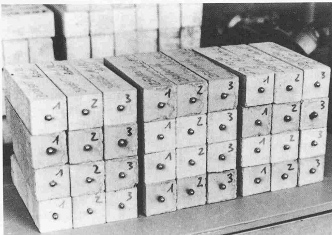
Bild 1. Versuchskörper. Links: Mörtelprismen 40×40×160 mm. Rechts: 3-Steinkörper
