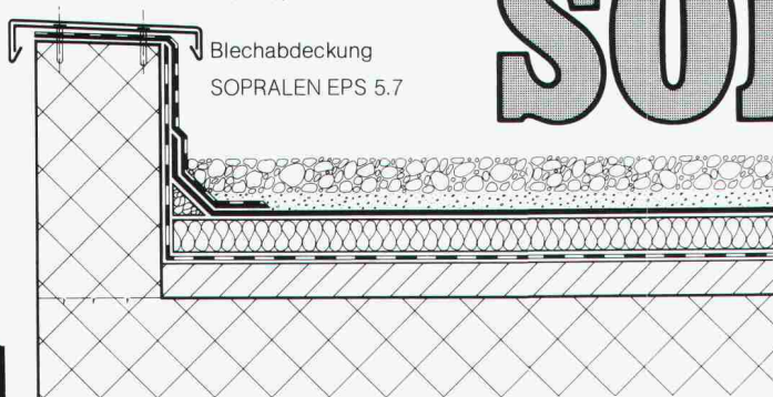
Schutzschicht SOPRALEN EJ 3.5 + EV 3.2 Wärmedämmschicht Dampfsperre
