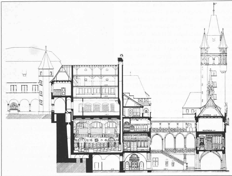
Längsschnitt durch den Grossratsaal
