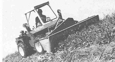
kung (Foto); 1975 Terratrac TT77 Mäher und Hanggeräteträger für Gelände bis 70% Neigung, Motor neben Lenker, extrem niedriger Bodendruck: Silbermedaille SIMA, Paris (Foto)
