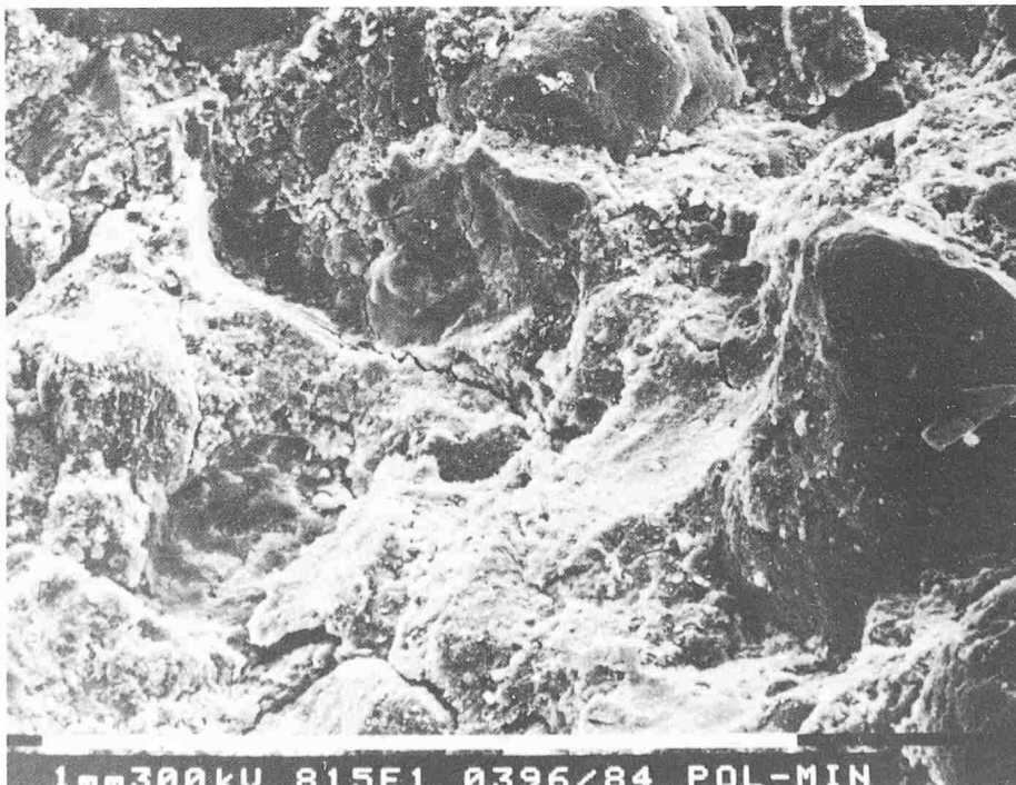
Bild 9. Übersichtsaufnahme. Normbeton PC 400. Vergrößerung 1:81,5
