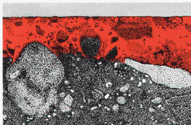
Sichtbare Eindringtiefe einer PERLTEX-Beschichtung auf dichtem Beton PC 300. Dargestellt in natürlicher Grösse.
