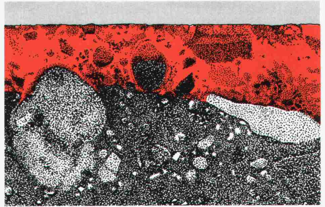
Sichtbare Eindringtiefe einer PERLTEX-Beschichtung auf dichtem Beton PC 300. Dargestellt in natürlicher Grösse.
