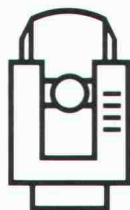
Kern E2 Elektronischer Sekunden- theodolit
