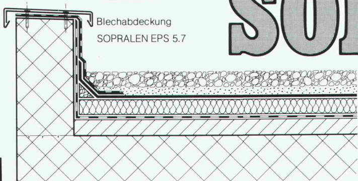
Schutzschicht SOPRALEN EJ 3.5 + EV 3.2 Wärmedämmschicht Dampfsperre
