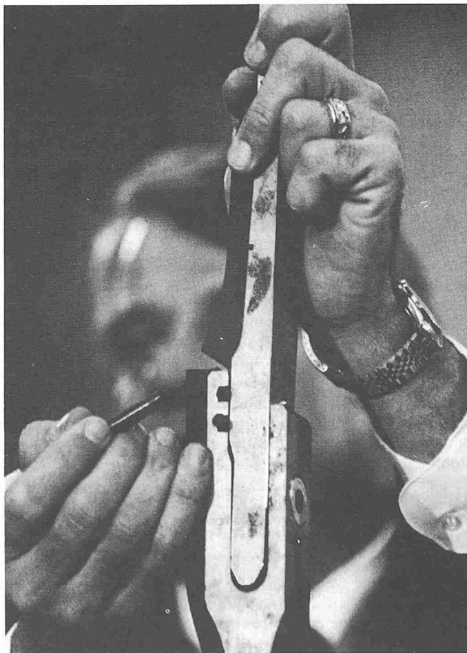
Bild 2. Querschnitt der Verbindungsstruktur zwischen den Teilstücken der Zusatzraketen. Der Zeigestift weist auf die Unterbruchstelle der inneren Isolationsschicht auf dem Stahlmantel (Bild Keystone/AFP Photo/Don Embert/db)
