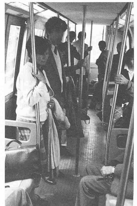
Bild 7. Mit nur 2,06 m Lichtraumbreite ist das Rollmaterial des VAL auch optisch recht schmal. Obwohl pro Wageneinheit 32 Sitzplätze angeordnet sind, zieht man es bei einigem Andrang schon vor, zu stehen – Ergebnis einer in Anbetracht der sonst so grosszügigen und unkonventionellen Konzeption nicht ganz verständlichen Sparsamkeitsanwendung. (Bild: Verfasser)
