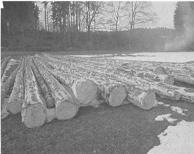
Bild 1. Beim Rundholz ist die Beurteilung der Qualität schwierig: Die qualitätsbeeinflussenden Merkmale wie Äste, Schrägfasrigkeit, Buchs, mechanische Schädigungen usw. sind nur schwer zu erfassen
