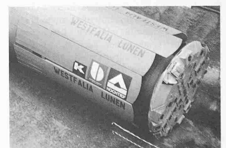
Bild 6. Vollschnittmaschine mit spreizbarem Messerschild (Erkundungsstollen Freudenstein-Ost)
