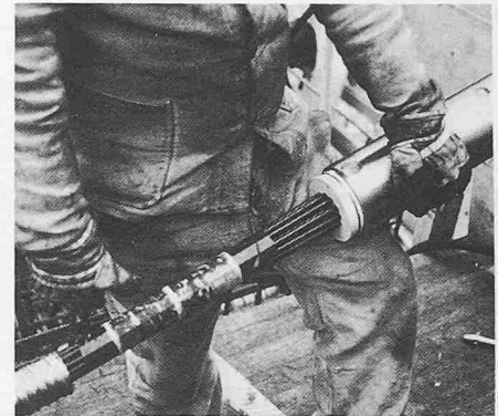
Bild 4. Glasfaserverbundstäbe als Vorspannbewehrung; 600-kN-HLV-Spannglied aus 19 Glasfaserstäben von 7,5 mm Ø
