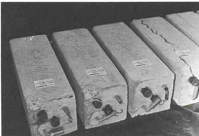
Bild 8. Die Betonprismen 1-3 (ohne Chloridzusatz) waren am Versuchsende noch intakt
