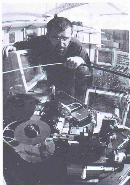
Die Versuchseinrichtung im Labor, vorne die Speicherplatte mit der Zugriffseinheit und auf dem Bildschirm oben rechts den Verlauf der Signalkurven, der für die spezielle Erkennungstechnik typisch ist (Bild: IBM)
