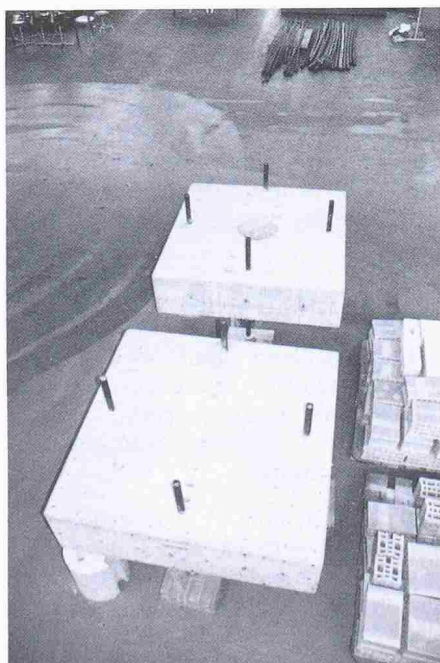
Bild 9. Ansicht der beiden Betonplatten. Vorn: Platte B (stark armiert), hinten: Platte A (schwach armiert)
