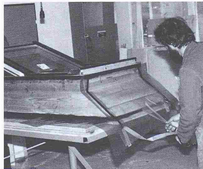
Die mit dem Fensterfutter ergänzten Dachflächenfenster werden im Werk mit der Dampfsperre (Bild), der Wärmedämmschicht und dem fugenlosen Unterdach versehen
