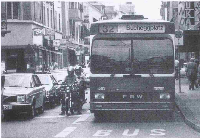
Bild 2. Strassenbahn und Bus müssen zähfließende oder stehende Autokolonnen zügig überholen können. Auf einer reservierten Strassenbahn- oder Busspur können fünf- bis zehnmahl mehr Personen befördert werden als auf einer Autospur
