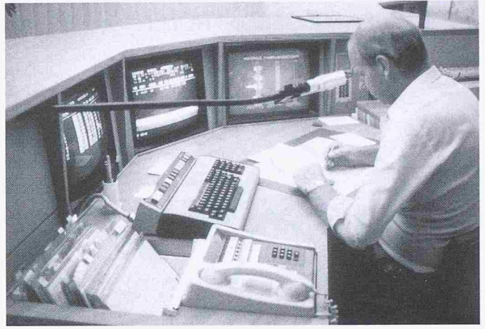
Bild 5. Das datengesteuerte Betriebsleitsystem erfasst jede Strassenbahn und jeden Bus auf 10 Meter genau. Der Computer vergleicht laufend den Ist- mit dem Soll-Standort und zeigt Abweichungen an, auf welche mit geeigneten Massnahmen – Einsatzfahrzeuge, Umleitungen usw. – reagiert werden kann
