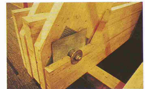
Bild 3. Schnittmodell eines Fachwerkknotens mit 2-teiligen Diagonalen und 3-teiligem Gurt. Der Gelenkbolzen ist eine Stahl-Stahl-Verbindung. Es gibt keine direkte Kraftübertragung zwischen dem Gelenkbolzen und dem Holzquerschnitt
