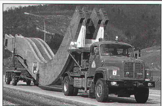
Unser Spezialfahrzeug, beladen mit den Hauptbogenträgern, unterwegs nach Neuchâtel. Der Transport von Holzkonstruktionen ist auch über weite Strecken wirtschaftlich.
