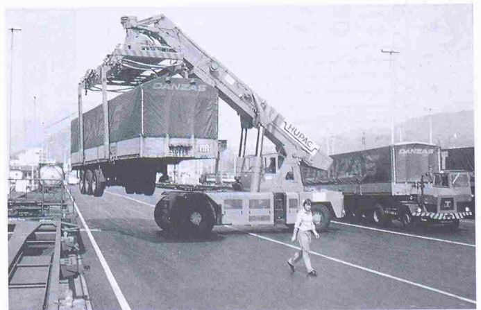
Per Huckepack werden nach den nötigen Anpassungsarbeiten auch Fahrzeuge bis zu 40 t mit der Bahn die Schweiz durchqueren können (Bilder: A. Gfeller, SBB)
