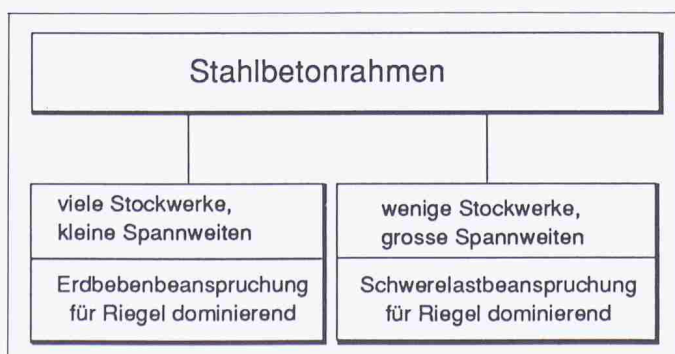
Bild 5. Arten von Stahlbetonrahmen
