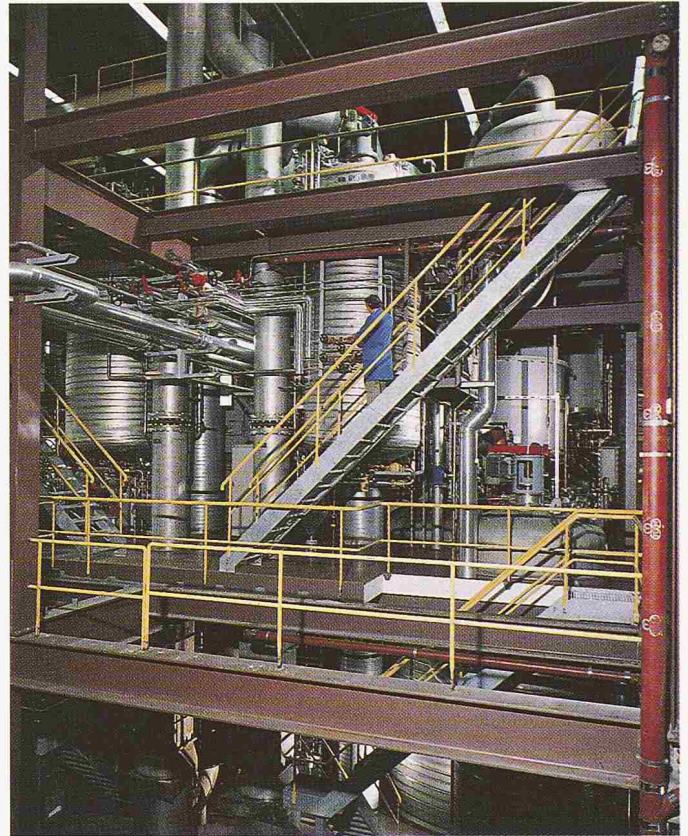
Bild 6. Teil einer Grossanlage für die Herstellung von Penicillin. In solchen Behältnissen wird mit dem in Bild 4 gezeigten Pilz dieses Antibiotikum hergestellt (Bild: Biochemie GmbH, Kundl, A)
