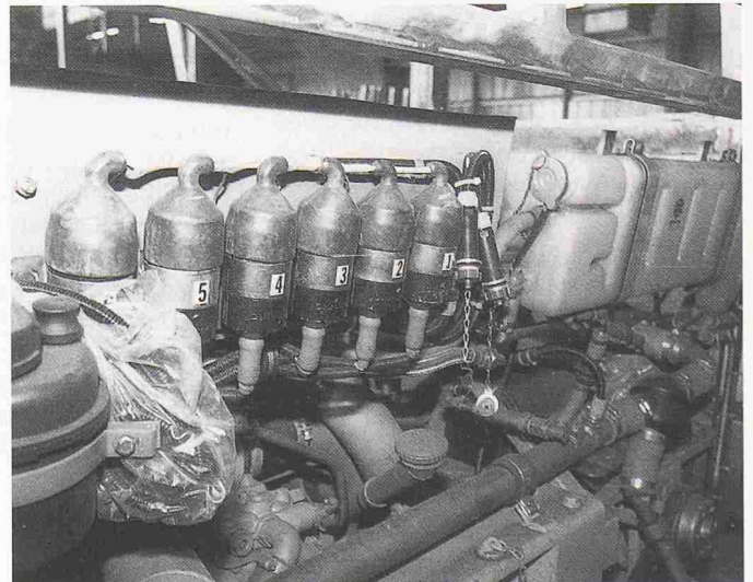
Methanoltechnik bei MAN: Zündspulen für Fremdzündung des Alkohol-Luft-Gemisches, das beinahe rückstandsfrei verbrennt (Bilder: Th. Renold)
