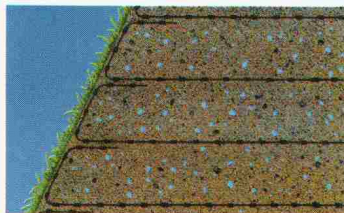
Die Bewehrung mit Tensar SR Geogittern ermöglicht die natürliche Begrünung von Böschungen.
