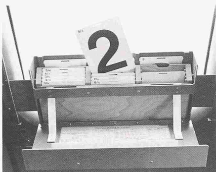
Bild 2. Geöffnete Kassette für die Anzeige der S-Bahn-Liniennummer in den älteren Fahrzeugen (Foto D. Heer)
