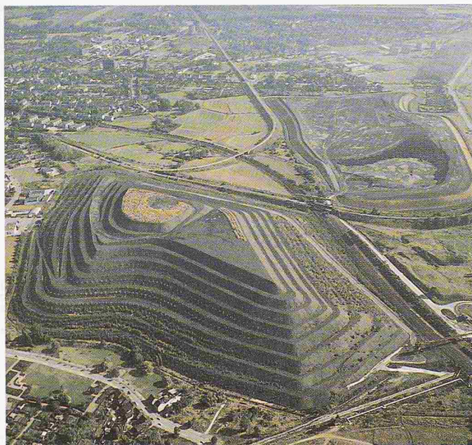
Bergehalden werden heute bereits während der Schüttung begrünt (Luftbild des Kommunalverbandes Ruhrgebiet)
