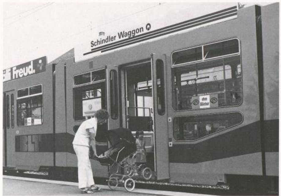
Bild 3. Das abgesenkte Mittelteil des BLT-Wagens erlaubt ein problemloses Einsteigen mit Kinderwagen. Foto: Schindler
