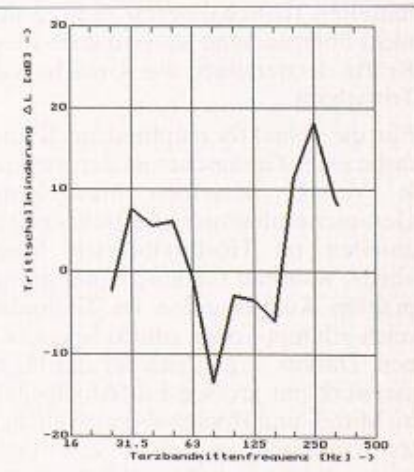
Unterlagsboden-Anordnung 6: Dämmmaterial zweilagig aus 1x20 mm dicken Schaumkunststoffplatten (nicht elastifiziert) und 1x11 mm dicken Trittschalldämmplatten (elastifizierter Schaumkunststoff)
