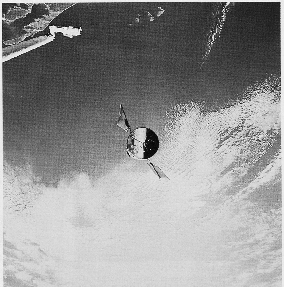
Die Raumfähre nähert sich dem havarierten Weltraumteleskop. Kurze Zeit später wird es durch Claude Nicollier mit dem Manipulatorarm erfasst und in die Ladebucht gehoben (Bild: Nasa/Archiv Schmidt)
