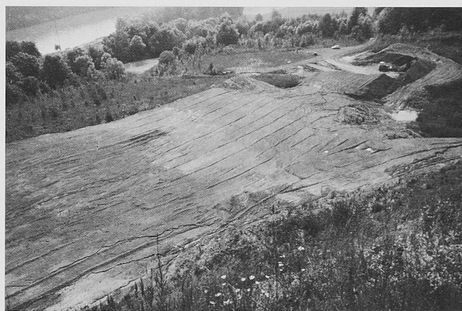
Bild 4. Offene Abbaufäche in der Schichtneigung verlaufend, unmittelbar nach dem Abbauvorgang (Tongrube Böttstein)
