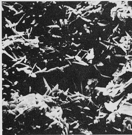
Kristalliner Gefügebau von Hebel-Porenbeton 3900fach vergrößert
