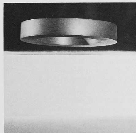
Grundversuch: Mit flüssigem Stickstoff gekühlte Yttrium-Barium-Kupfer-Oxid-Probe schwebt im statischen Magnetfeld von 0,5 Tesla, gehalten durch supraleitende Dauerströme
