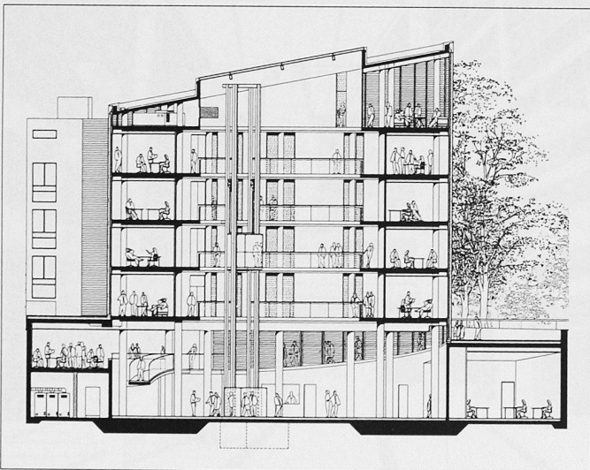
Oben: Querschnitt mit Rundhof und Lifanlage
