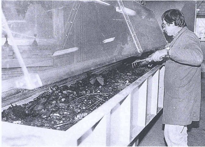
Bild 1. Störstoffe – vor allem Plastik- und Blechteile – werden von Hand separiert
