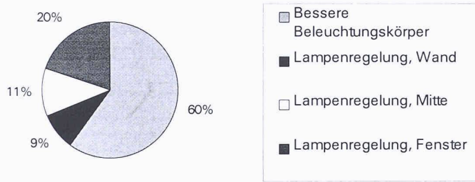
Bild 5. Aufschlüsselung nach Ursache der Einsparungen im Zimmer mit Innenlichtregelung
