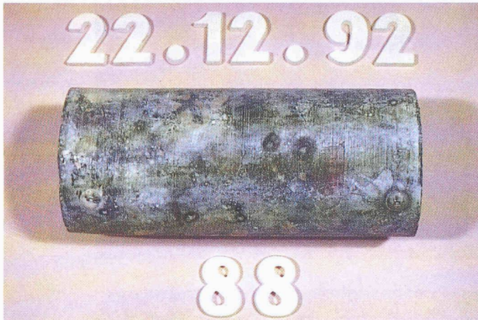
Bild 11. Betonprobekörper CEM I 52.5 + 10% Mikrosilica Sikacrete CE nach 96 Wochen Sulfatlagerung, ohne sichtbare Schäden
