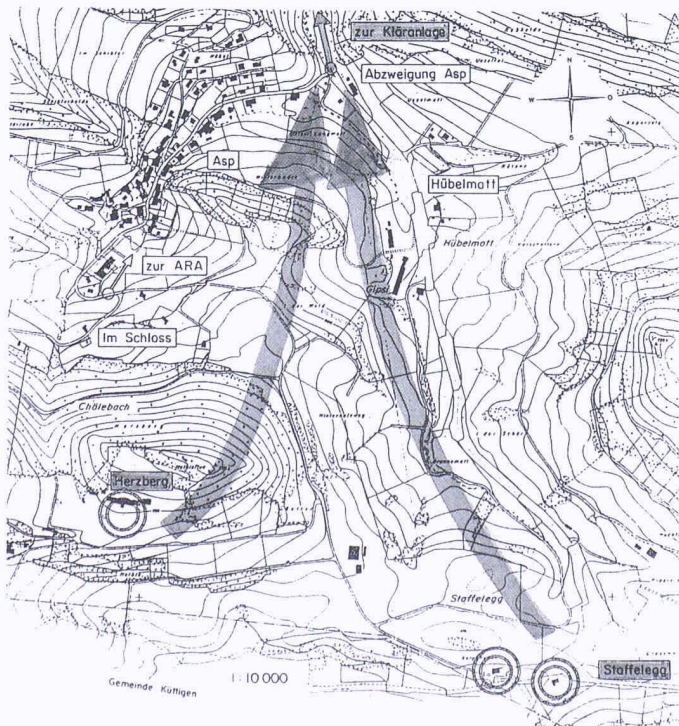
Skizze zur Problemstellung. Kreise: anzuschliessende Liegenschaften; kleiner Pfeil oben: Anschlussstelle an Kanalisation
