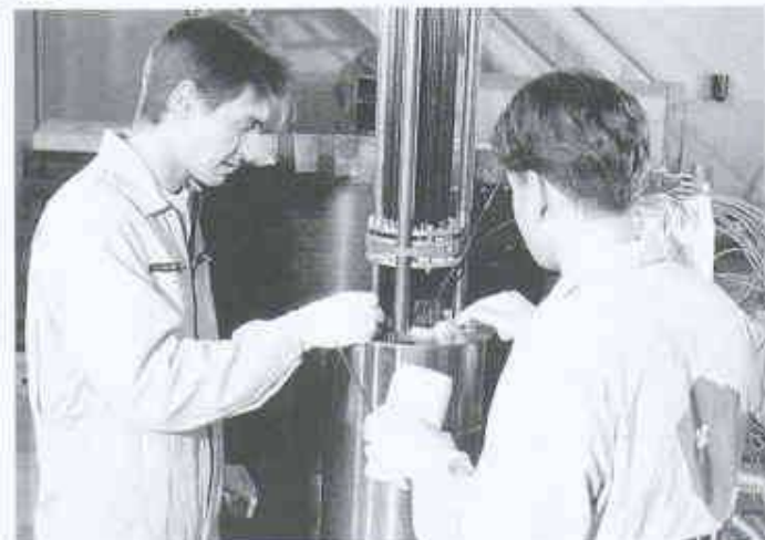
Einfüllen der Glasfaserschnitzel in die Stahlhülse
