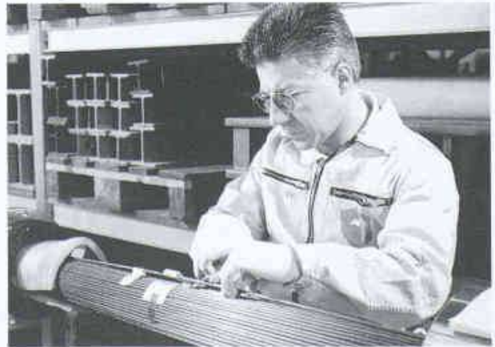
Aufbringen von Sensoren für die Langzeitmessungen
