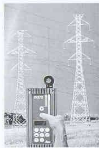
Leica Power Disto bei der Höhenbestimmung von Starkstromleitungen
