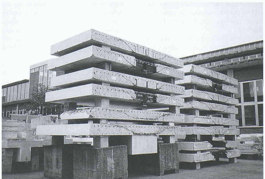
Bruchbild in den zentrisch durchgeschnittenen Versuchskörper
