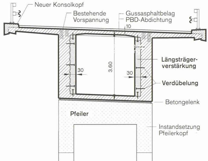
10 Längsträgerverstärkungen
