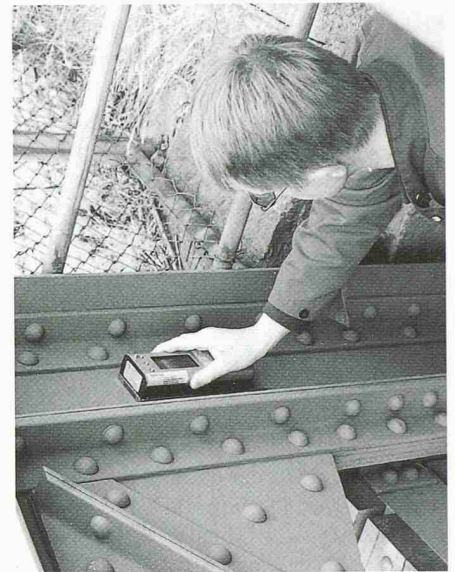
1 Das Gerät im Einsatz bei der Bestimmung des Bleigehalts von Korrosionsschutzanstrichen an einer Eisenbahnbrücke
