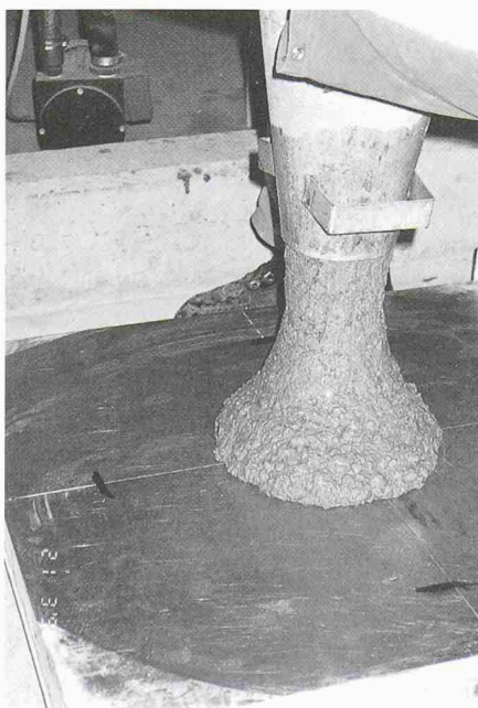
3 Bestimmung der Konsistenz von SCC mit dem «slump flow», gemessen wird das «Ausbreitmass» (Bild: Sika)
