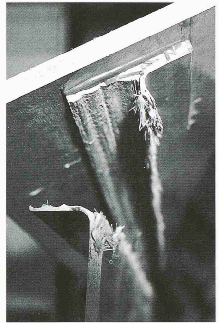
Bruch im Profil, Klebestelle intakt
