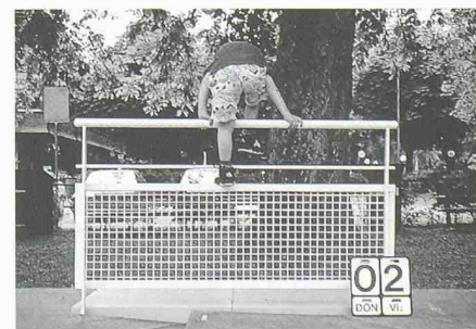
2 Modellversuch der bfu zur Übersteigbarkeit von Geländern mit dem Ziel, Aufschluss über die motorischen Fähigkeiten von Kleinkindern zu erhalten. Im Bild ein Geländermodell, das den Anforderungen nach SIA 358 entspricht, mit einem viereinhalbjährigen Kind
