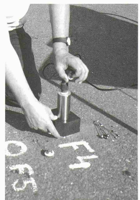
7 (rechts) Impact-Echo-Messgerät in der praktischen Anwendung
