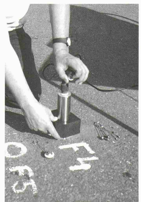
7 (rechts) Impact-Echo-Messgerät in der praktischen Anwendung
