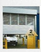
llenabschlüsse gefragt. Das neue Speed-Rolltor HSR aus Aluminium ist für hohe Beanspruchung im Dauerbetrieb ausgelegt und öffnet mit einer mittleren Geschwindigkeit von ca. 1,2 m/sec. Der Schliessvorgang erfolgt mit ca. 0,5 m/sec. Schnelles Öffnen und zügiges Schliessen vereint das neue Speed-Rolltor mit einem praktisch verschleissfreien Lauf seines völlig glattflächigen Torblattes aus doppelwandigen, nach DIN 17611 eloxierten Aluminium-Profilen.
