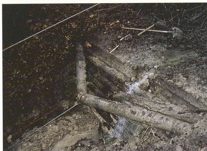
4 Biegebruchversuch an einer einwandigen Holzsperrung. Das Rundholz ist in Balkenmitte und bei der rechten Einbindung gebrochen (in Fließrichtung betrachtet). Als Kraftquelle diente eine traktorbetriebene Seilwinde
